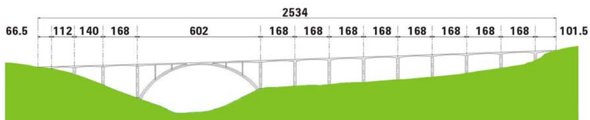
Viaduc en arc central
