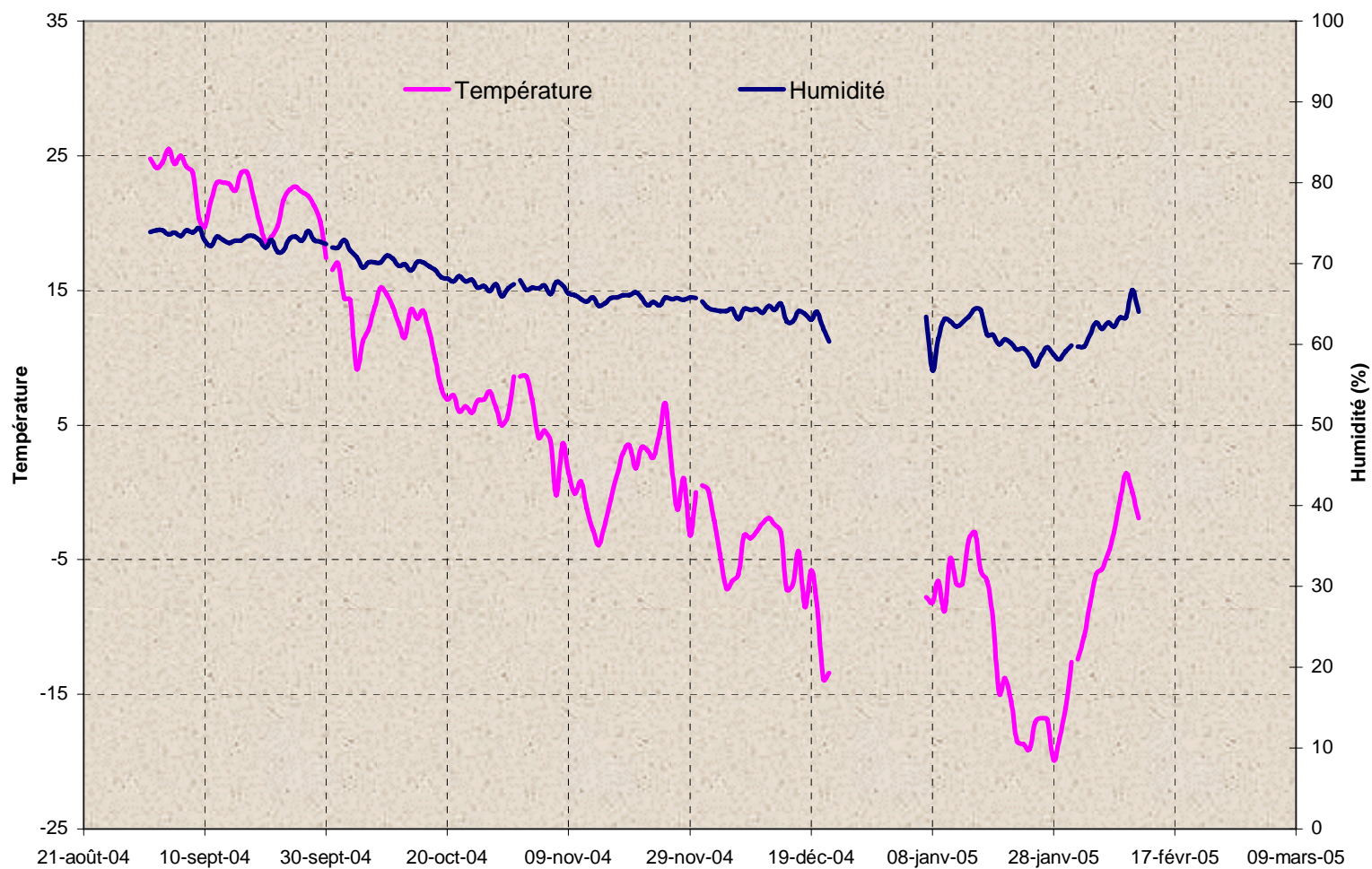
GRAPHIQUE 1 Évolution de la température et l'humidité du béton entre août 2004 et mars 2005
