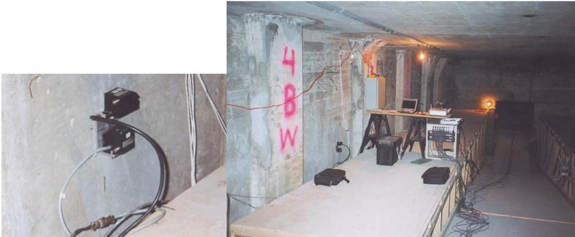
Figure 8 : a- Accéléromètre EPI-SENSOR, b- système d'acquisition de données
