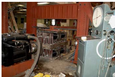
Photo 2 : Essais de conformité à la norme S6-00 de deux prototypes
