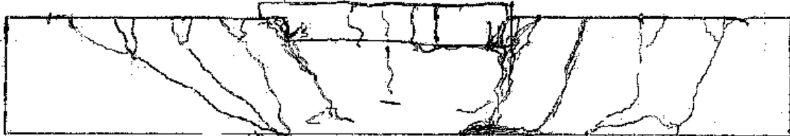
Fissuration de la poutre renforcée – vue de côté
