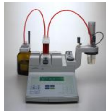
Photo 4 – Dosage des chlorures
