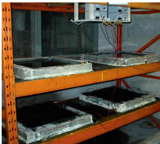
Figure 1 □ Montage utilisé pour l'évaluation de la résistance à la corrosion
