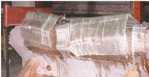
Figure 5 : Rupture par décollement du chemisage en PRF
