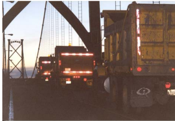
Figure 2.c : Passage du chargement de 3 camions pesés.
