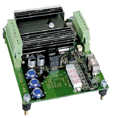
**Figure 1 – Limiteur de vitesse électronique type (Woodward Governor Company, 2007)**
