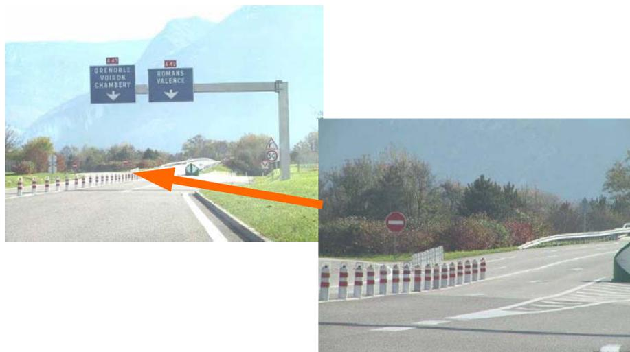
Au niveau de la jonction des 2 bretelles de sortie, le panneau de danger signalant un carrefour classique AB1 (croix) est remplacé par un panneau C28 (1 voie +1 voie) ou C29 (2 voies en 1).
