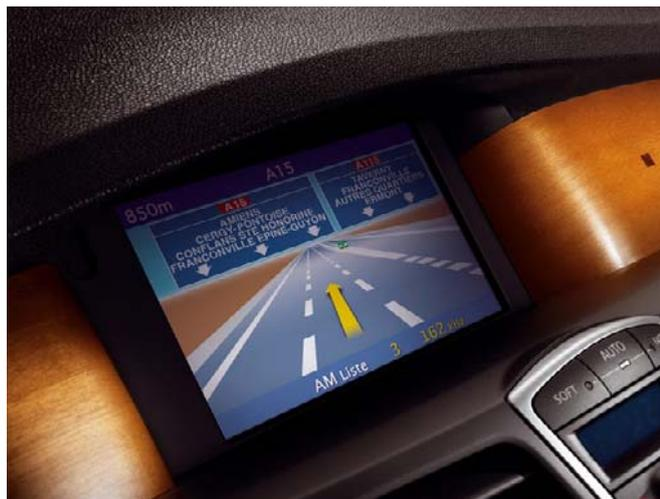
Figure 23 : exemple de système embarqué fourni dans les véhicules du groupe Renault
