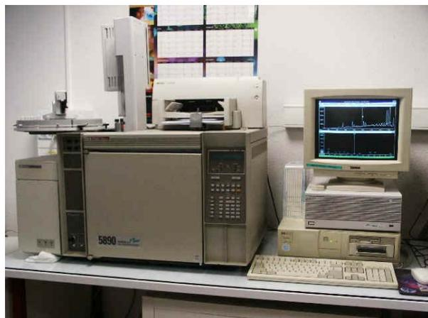
Figure 8 : Exemple de chromatographe en phase gazeuse – GC/MS
