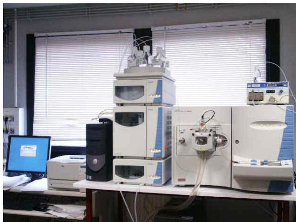
Figure 9 : Exemple de chromatographe en phase liquide – HPLC/MS
