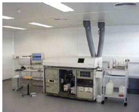
Figure 12 : Exemple ICP/MS
