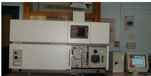
Figure 11 : Exemple ICP/AES
