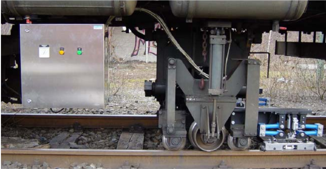
Figure 13 Système de mesure par courants de Foucault installé sur un train meuleur 48
