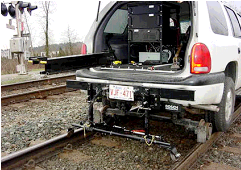
Figure 8 Système de mesure de l'état géométrique de la voie Solid Track de Andian Technologies
