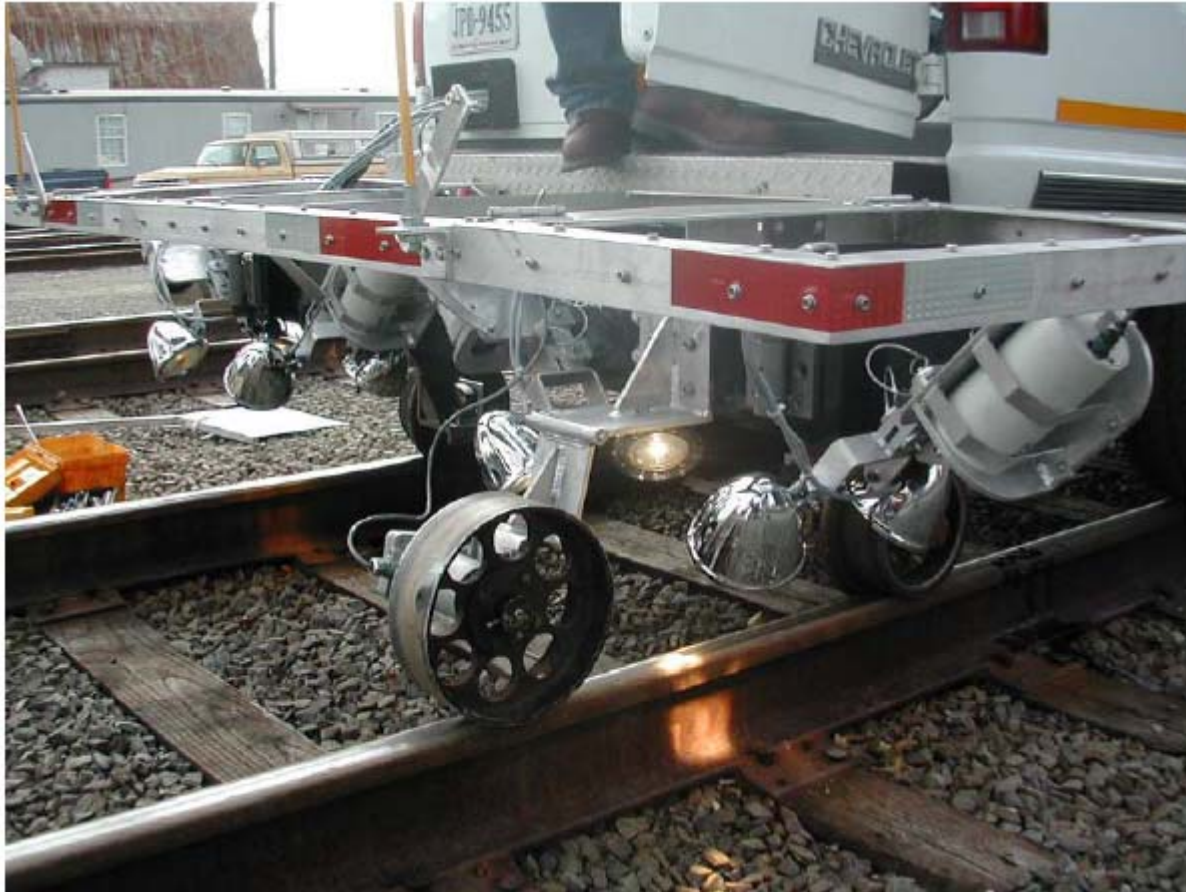
Figure 14 Prototype de système d’inspection des éclisses monté sur un véhicule rail-route 51
