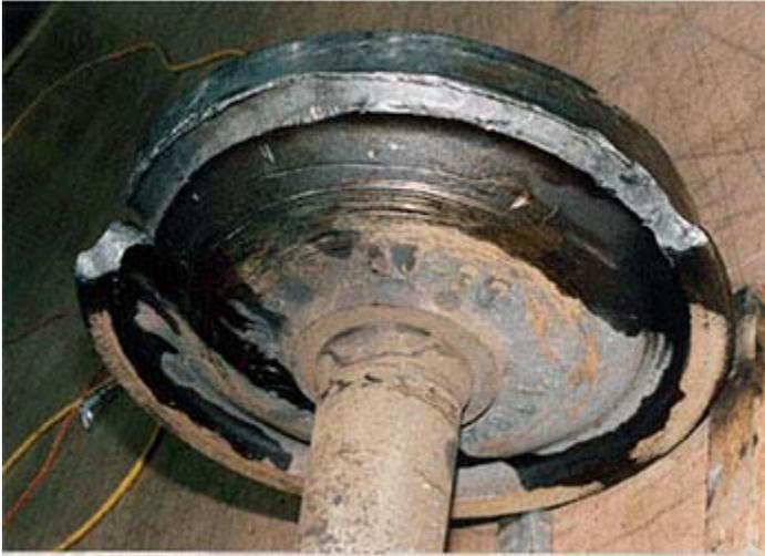
**Figure 12 Photo d'une fracture de la jante d'une roue de Southern**
