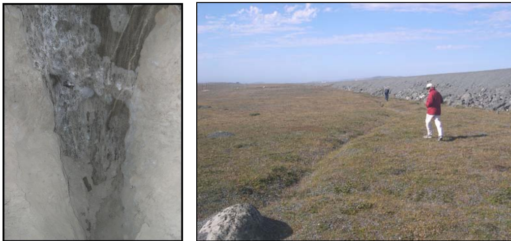
Figure 3: Coins de glace dans le tunnel de pergélisol (Alaska) et sillon de coins de glace aux abords de la piste d'Akulivik (Nunavik)
