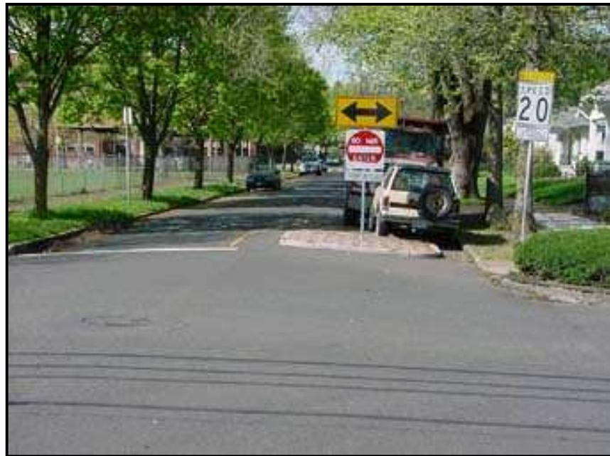
**Figure 28** Avancée à mi-chaussée de type sortie seulement à Austin, États-Unis
