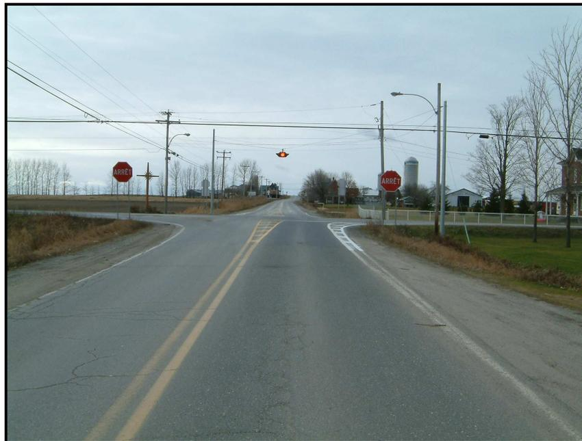
**Figure 61** Îlots en marquage avec texture intégrée implantés à l'intersection
