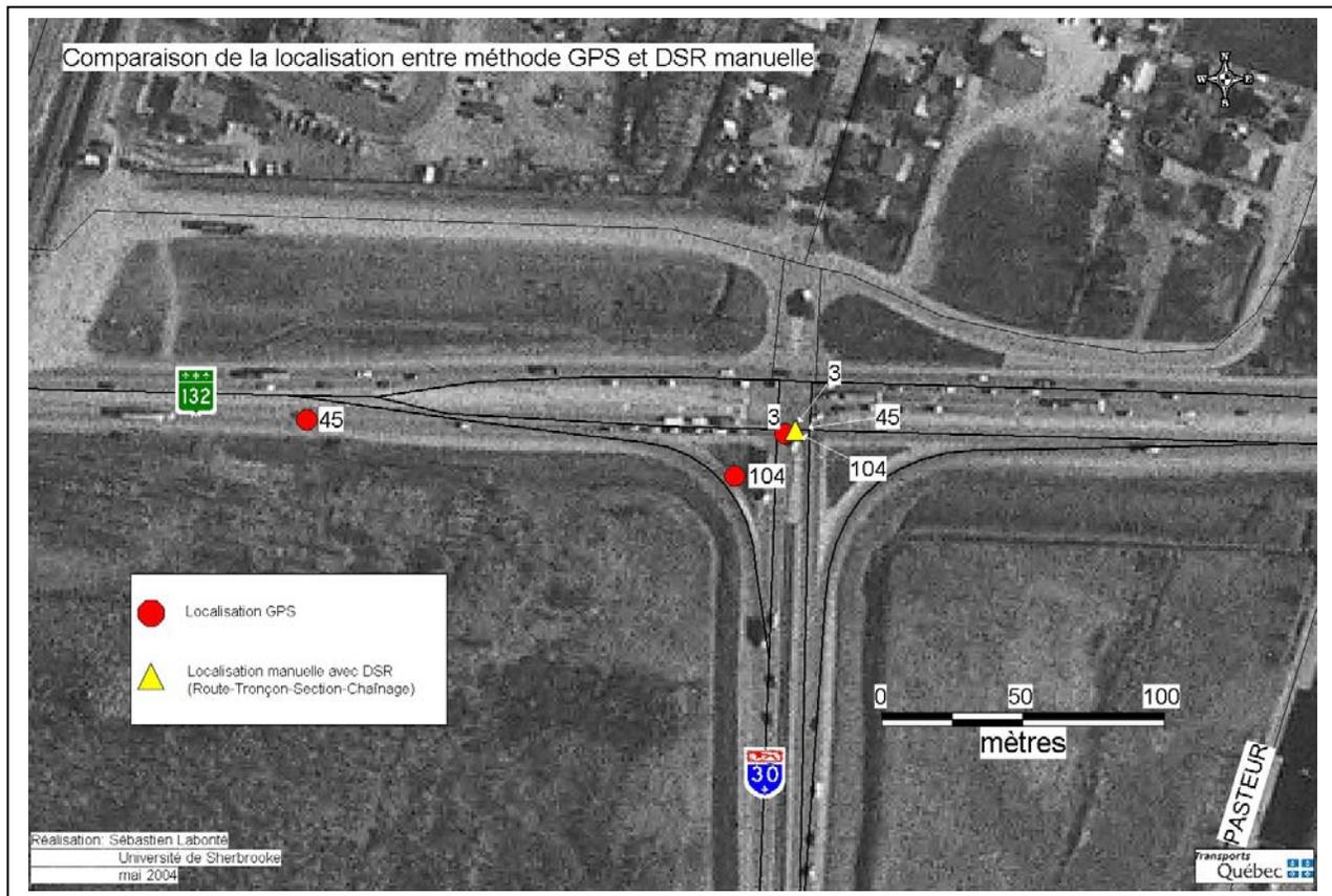
**Figure 9 - Comparaison de la localisation entre la méthode GPS et DSR manuelle (route 132/autoroute 30)**
