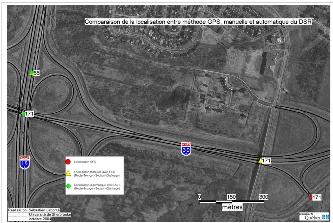
**Figure 11 - Comparaison de la localisation entre la méthode GPS et traditionnelle (manuelle et automatique)**
