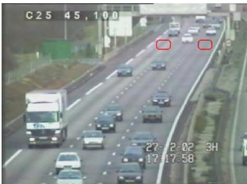
Figure 7 : Image fournie par la caméra de surveillance au PR 45+100. Les cadres rouges représentent les taches infrarouges des capteurs situés sur PMV. Tous les véhicules passant dans ces cadres sont comptabilisés.
