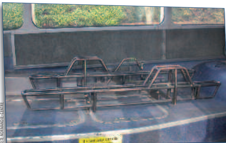
À Rouen, dispositif d'accroche de vélos positionné à l'intérieur des cars de la ligne 1.
