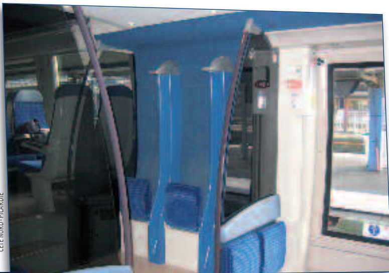
Dispositif d'accroche de vélos dans un TER de la région Nord - Pas-de-Calais avec possibilité de modulation en siège passager.
