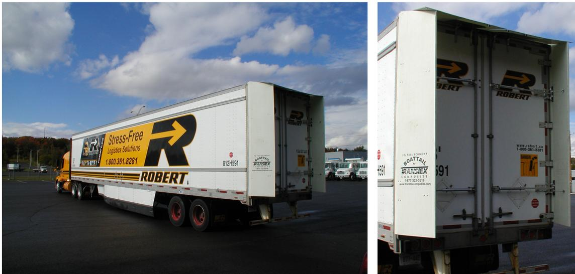
**Figure 3.6:** Configuration *Seskbt* (“Side extender + side skirt + boat tail” avec pneus jumelés).
