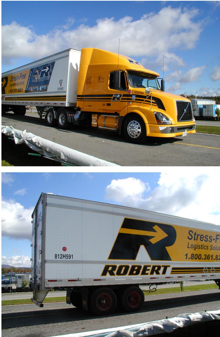
**Figure 3.3:** Configuration du véhicule de base monté sur pneus jumelés.
