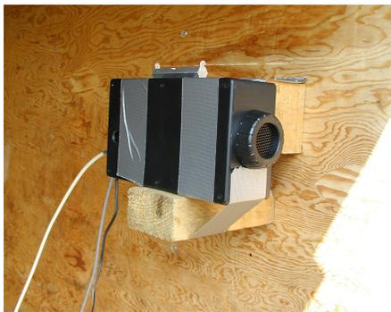
**Figure 1.8:** Appareil de mesure à ultrasons de la position latérale du camion.
