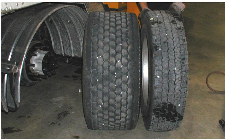
**Figure 3.2:** Comparaison entre un pneu standard (servant à faire une configuration de pneus jumelés) et un pneu simple.
