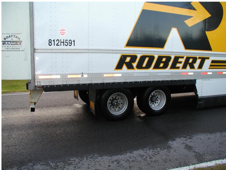
**Figure 3.7:** Configuration *SeskbtstfS* (“Side extender + side skirt + boat tail + side flaps” avec pneus simples).
