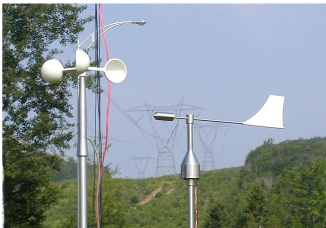
**Figure 1.9:** Anémomètre et girouette.
