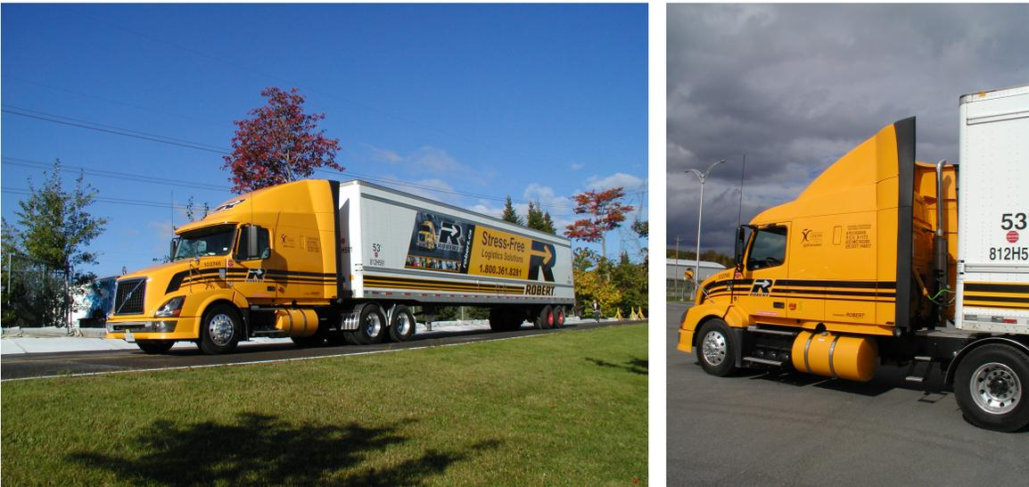
**Figure 3.4:** Configuration *Se* (“Side extender” avec pneus jumelés).
