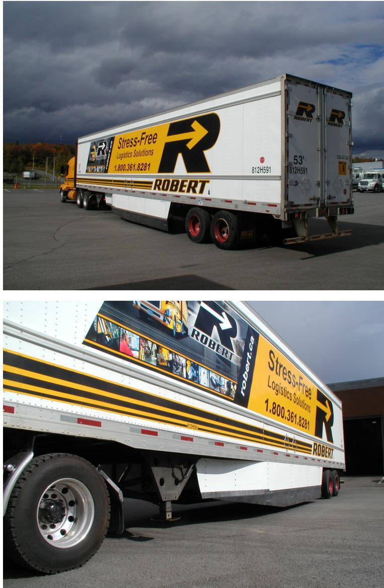
**Figure 3.5:** Configuration *Sesk* (“Side extender + side skirt” avec pneus jumelés).
