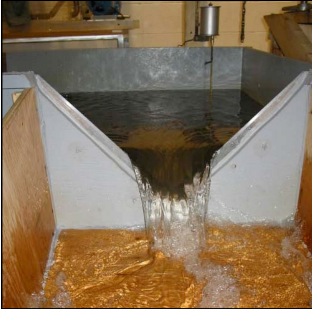
Fig. 4.5 - Bassin équipé de déversoir, sonde et filtre
