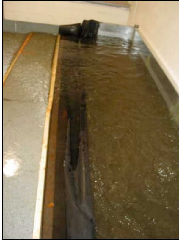
Fig. 4.2 - Réservoir d'alimentation en eau
