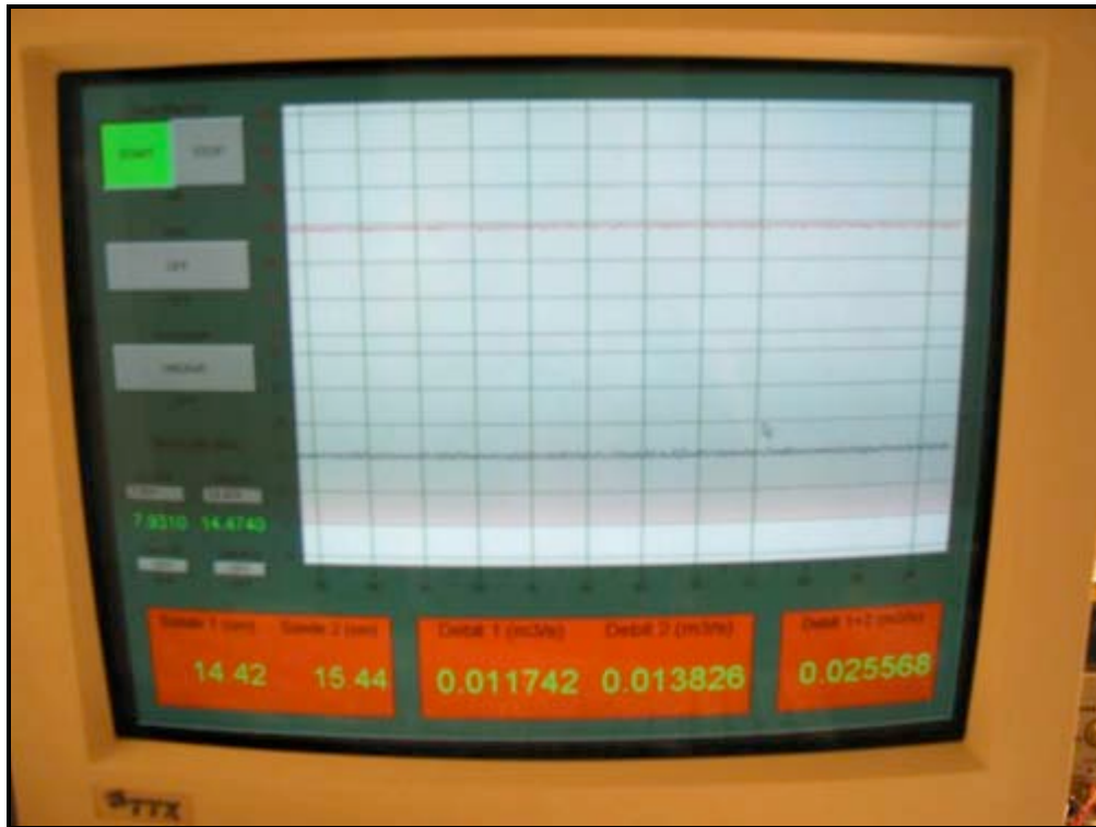
Fig. 4.7 - Système d'acquisition automatique de données (Interface DASYlab)
