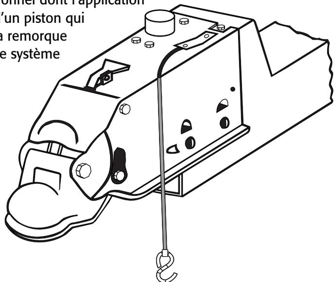
Dispositif d'application pour freins hydrauliques à inertie
