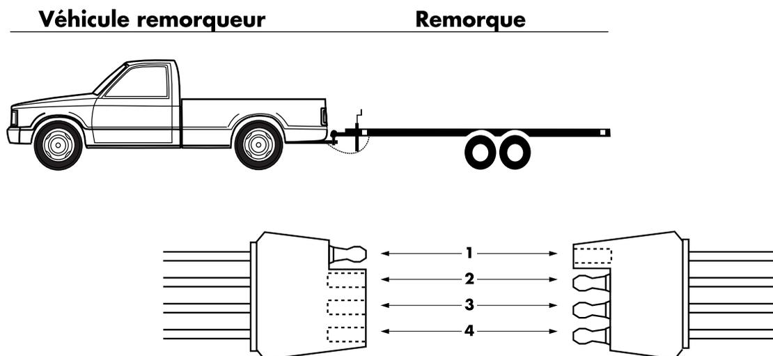
**Note :** Il est important de raccorder chacun des conducteurs à leurs positions respectives sur les deux fiches (véhicule remorqueur et remorque) afin d'éviter des troubles éventuels, tels que court-circuit ou inversion des signaux de changement de direction de la remorque. Une telle inversion fait en sorte que le feu de changement de direction droit de la remorque s'allume lorsque le conducteur du véhicule signale son intention de tourner à gauche et vice versa.
