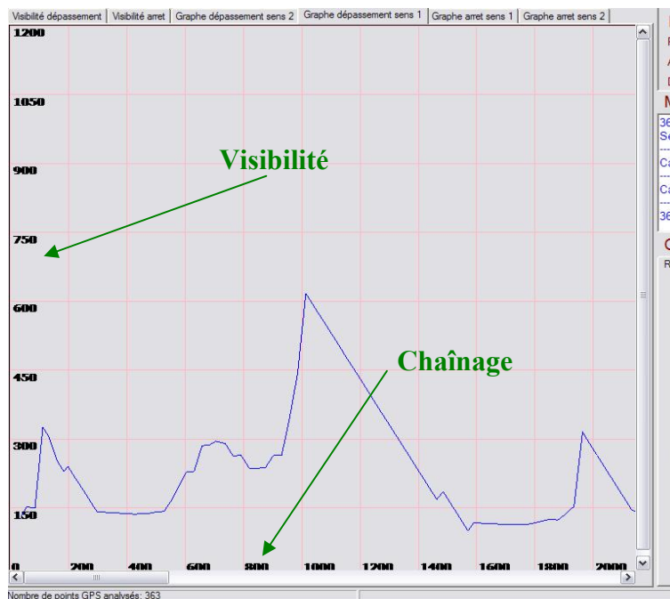
Figure 7.14: Panneau résultats du calcul de visibilité. L'onglet « Graphe visibilité dépassement sens 1 » est activé.
