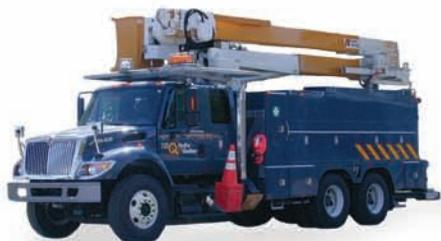
Camion élévateur à nacelle (10 roues)
