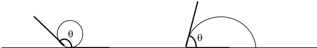
**Figure 4 Angle de contact**
