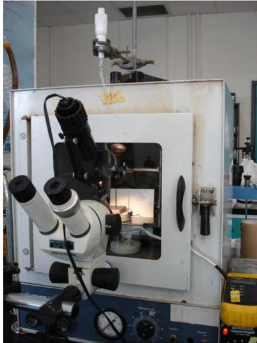
Figure 5 Montage expérimental pour les mesures d'angle de contact
