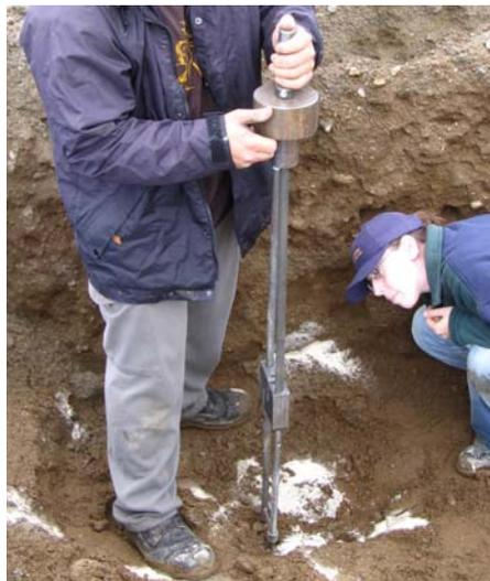
**Figure 23 : Essai au pénétromètre à cône dynamique**
