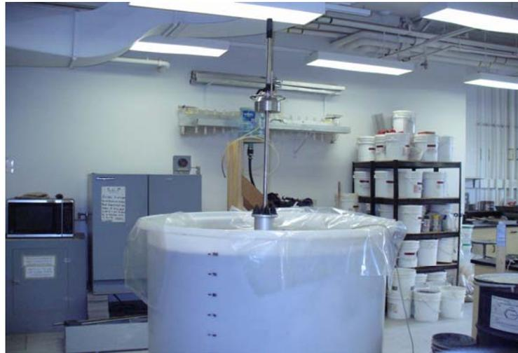
**Figure 17 : Essai au FWD pour le sol lâche et drainé**
