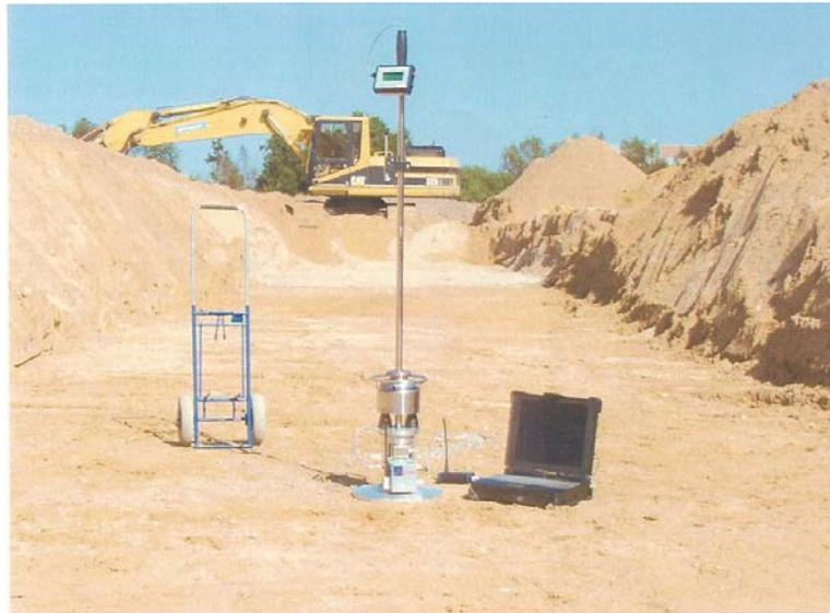
**Figure 7 : Défectomètre à masse tombante (d'après Carl Bro *et al.*, 2006)**
