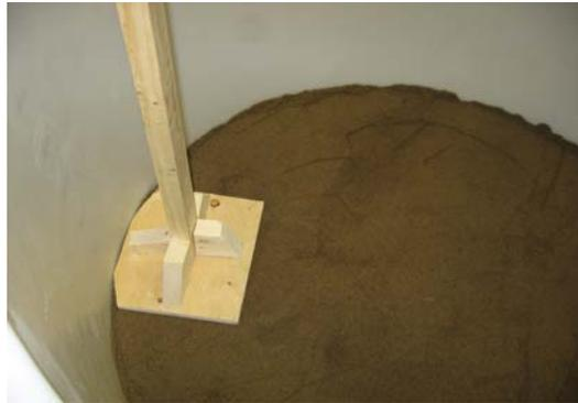
**Figure 15 : Mise en place du sol lâche avec le pilon de bois**
