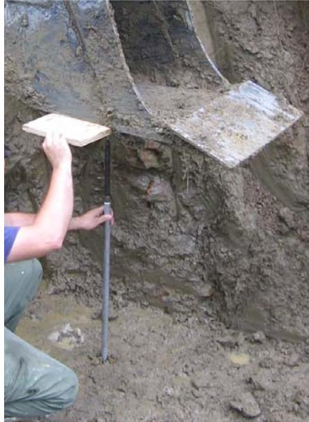
**Figure 24 : Essai au scissomètre**
