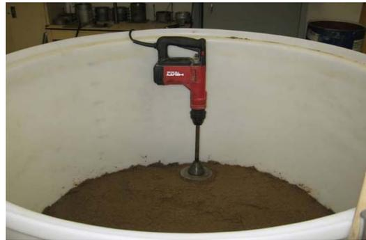
**Figure 19 : Mise en place du sol dense avec le marteau vibrant**
