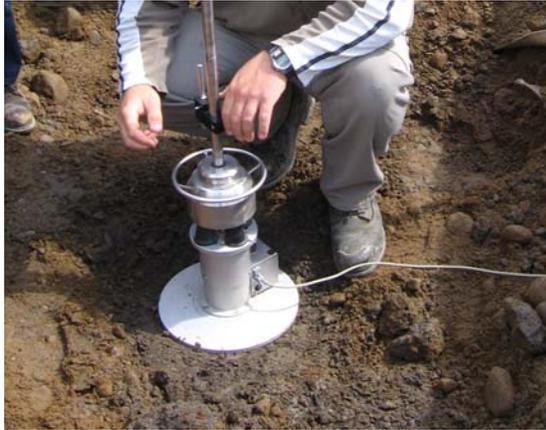
**Figure 22 : Essai au déflectomètre à masse tombante portatif**
