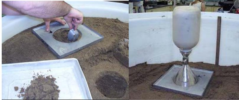
**Figure 18 : Essai au cône de sable**
