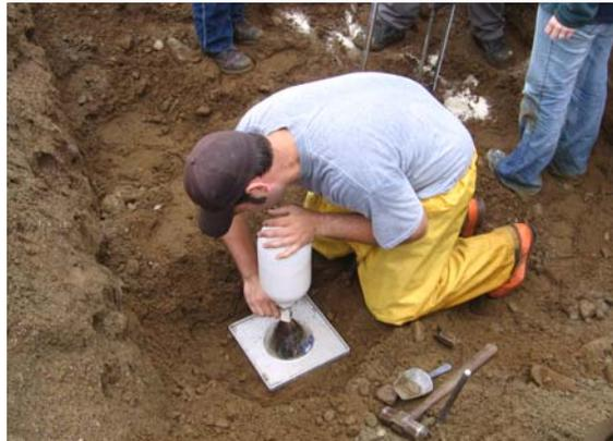
**Figure 25 : Essai au cône de sable**
