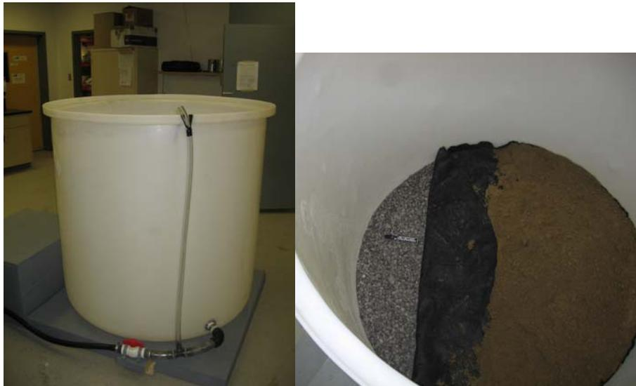
**Figure 14 : Cuve d'essais et couche de fond**
