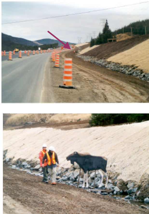
Figure 2. Exemple de station d'observation (route 175, km 84). La flèche indique la position de la silhouette (noir) et d'un observateur (orange) à 200 m.
