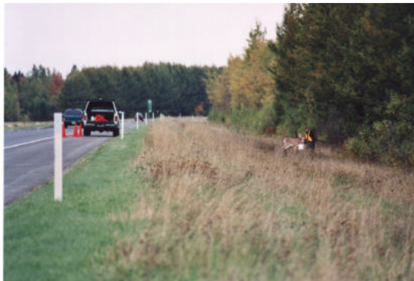
Exemple de mesure du seuil de visibilité de la silhouette de cerf vue de l'observateur situé à 200m
