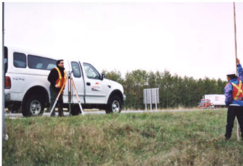
Exemple de calcul de la pente au moyen d'un niveau
