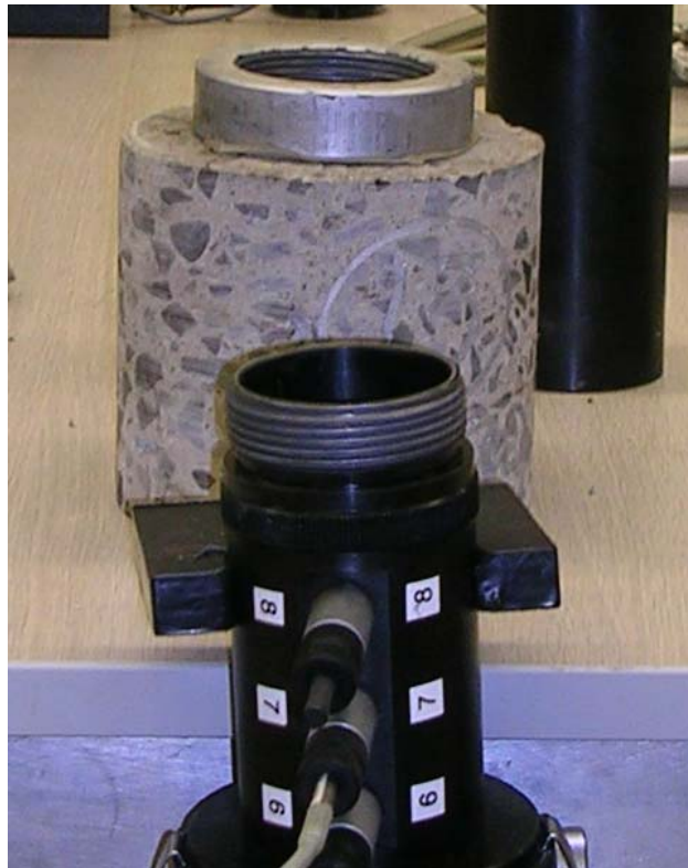
Figure 6 : Tube de Kundt en position verticale et échantillon prêt à être testé
