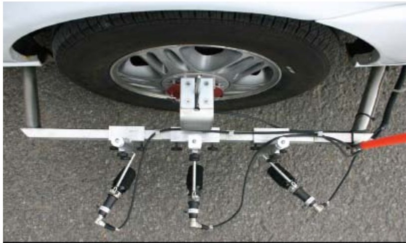
Figure 12 : Audiomètre routier dynamique développé par le MTQ [2]
