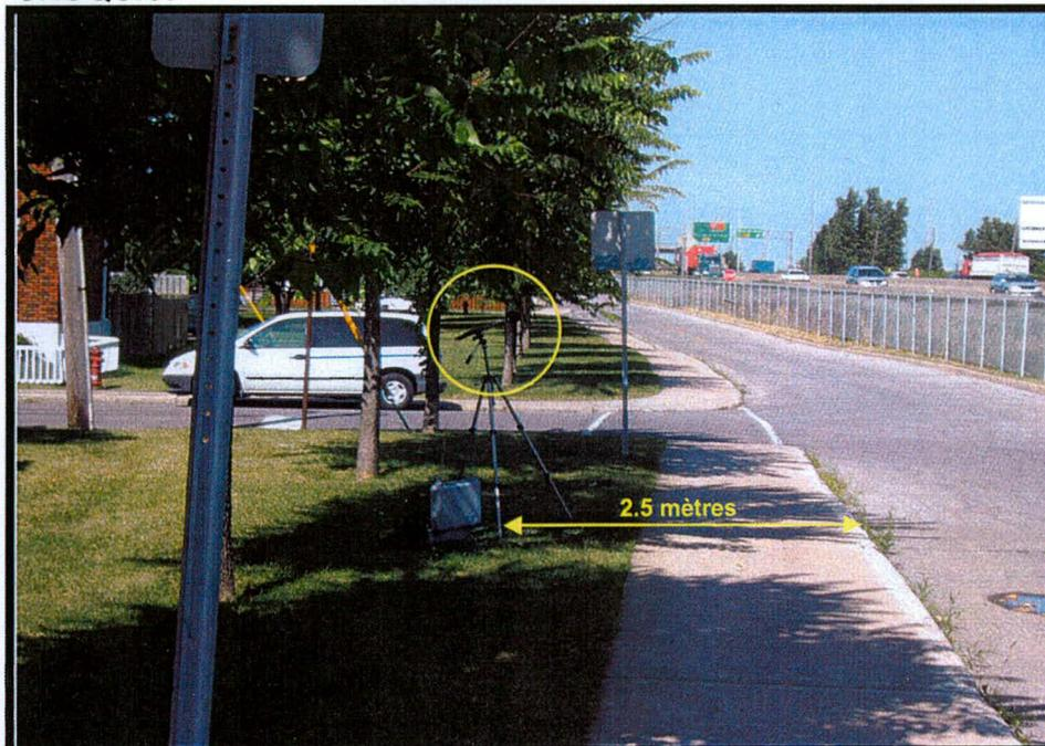
Le sonomètre est situé à environ 2.5 mètres du bord du trottoir.
