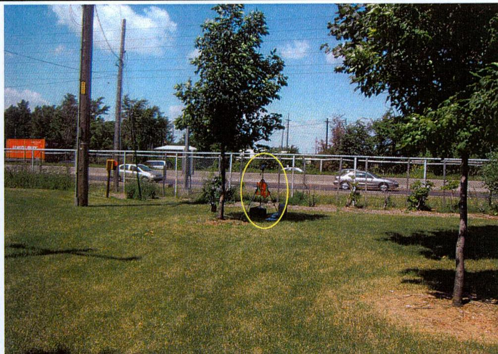
Le sonomètre est situé à environ 6.3 mètres de la clôture d'emprise.
