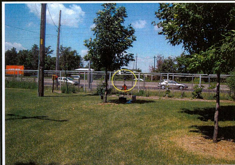
Le sonomètre est situé à environ 5.7 mètres de la clôture d'emprise.
