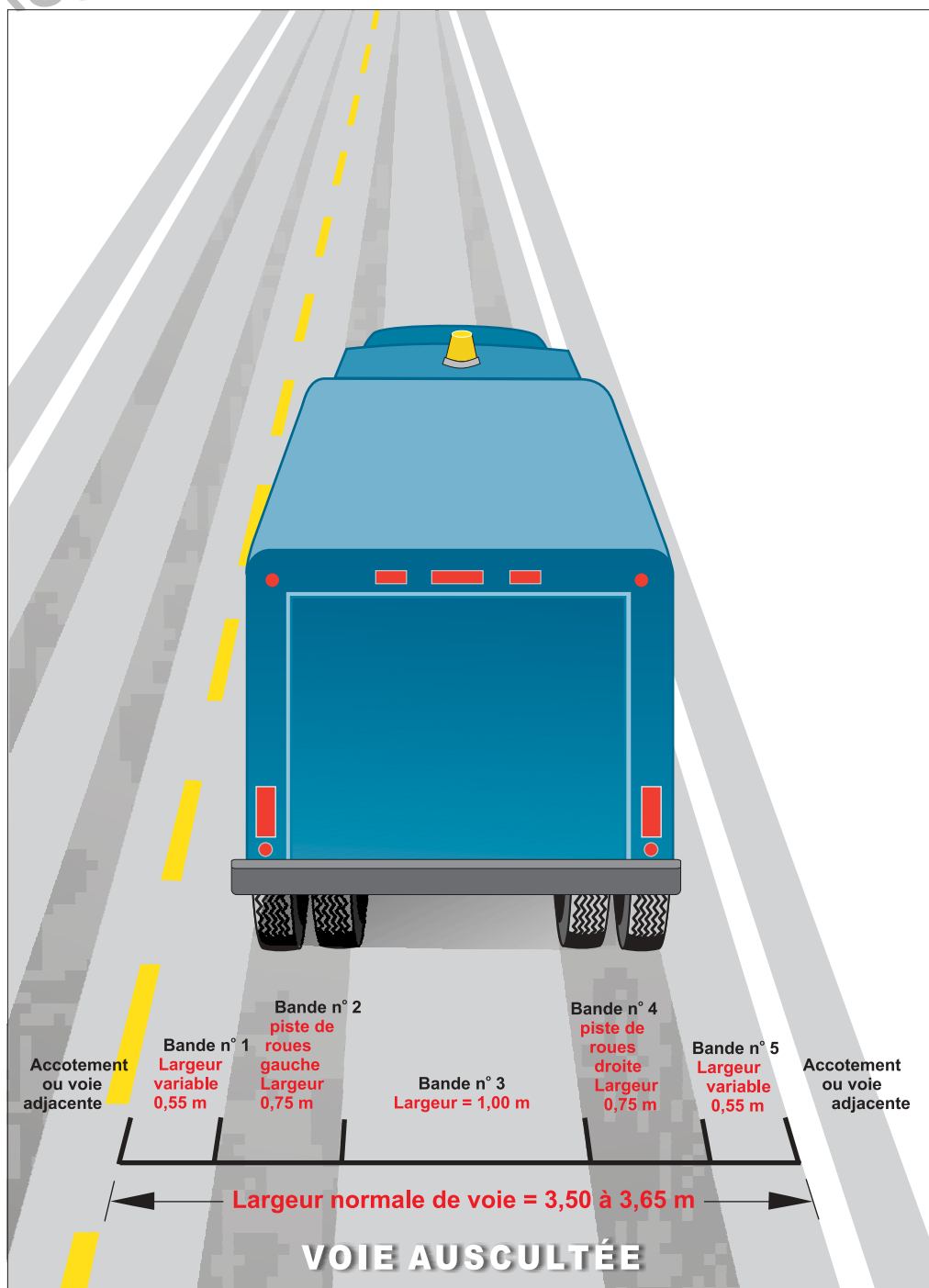
Figure 1-1 Détails des bandes d'auscultation pour la fissuration
