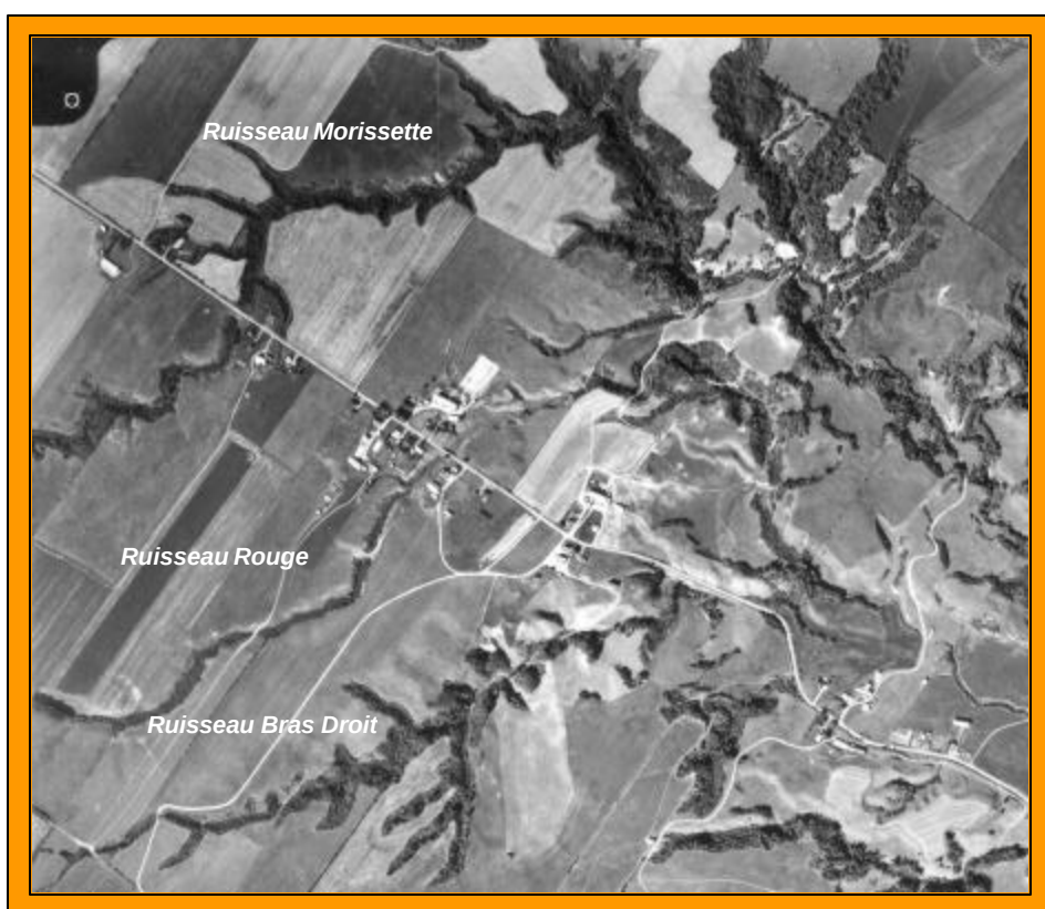
Figure 56 : Photographie aérienne illustrant un bassin de drainage de forme dendritique, typique des cours d'eau qui se développent sur une plaine argileuse (secteur 2, fig. 53.).
