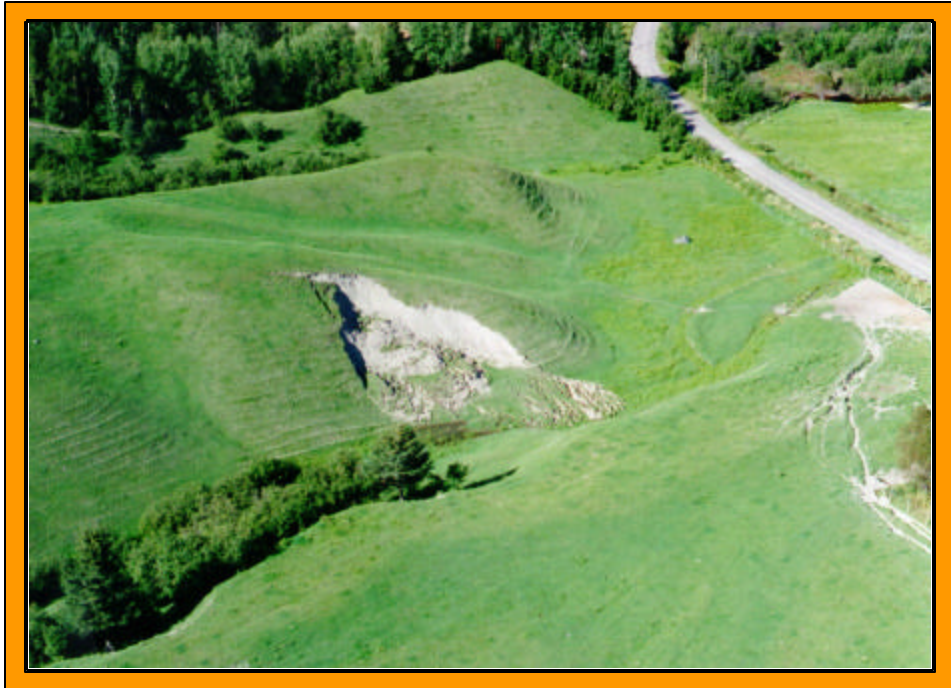
Figure 21 : Exemple de décrochement; rang Dorval, Larouche.
