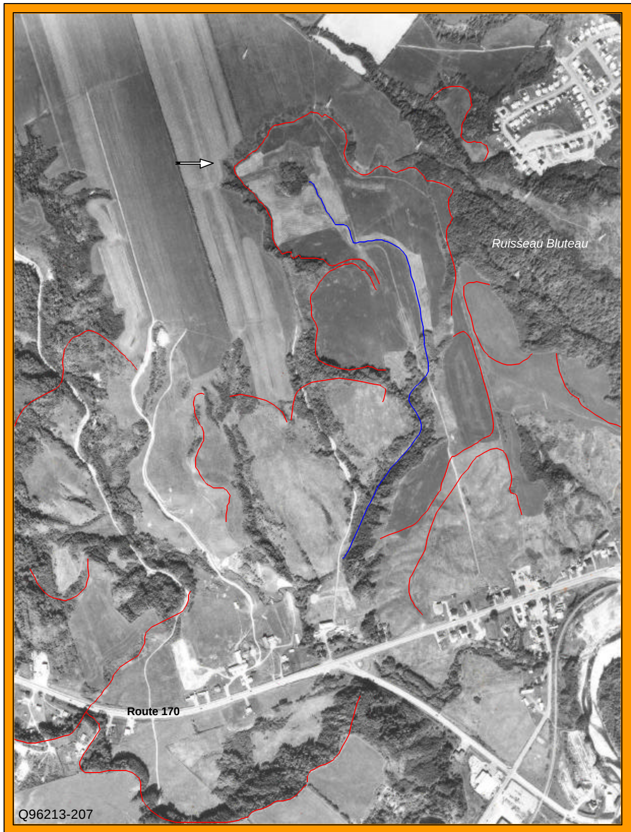
Figure 57 : Photographie aérienne montrant des cicatrices de coulées argileuses dont une immense (flèche) amorcée à la tête d'un ruisseau adjacent au ruisseau Bluteau, La Baie.
