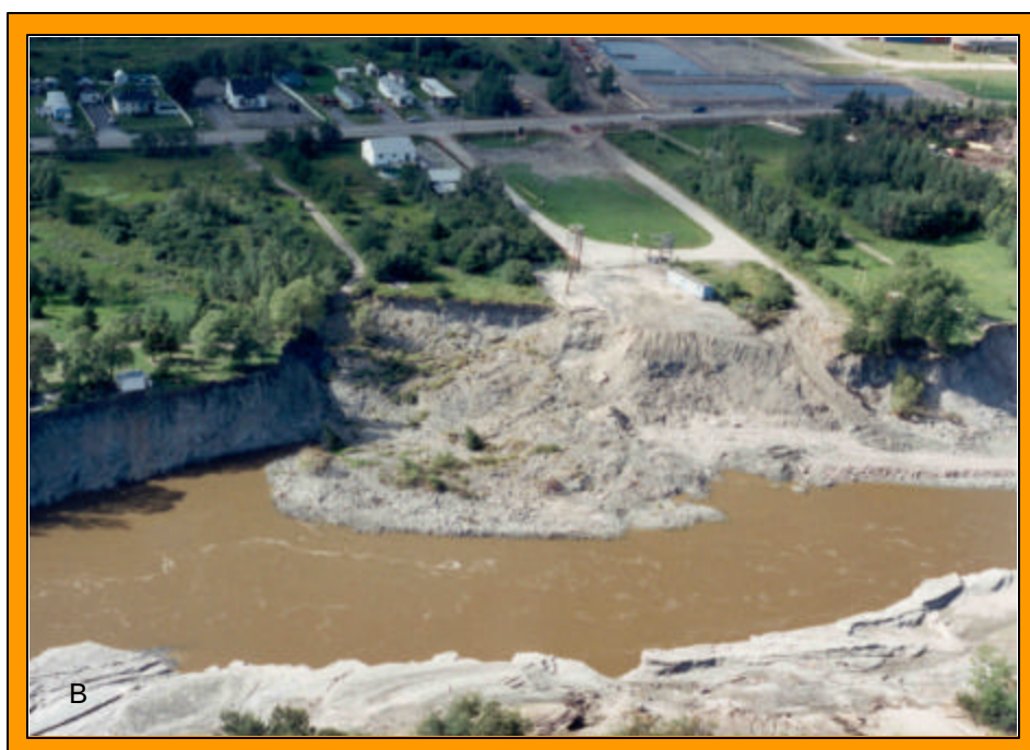
Figure 6 : Nouvelle falaises instables sur la rivière Chicoutimi, en amont du barrage Pont-Arnaud, avant (A) et après (B) l'apparition d'un glissement de terrain majeur survenu quelques jours après le retrait des eaux d'inondation.
