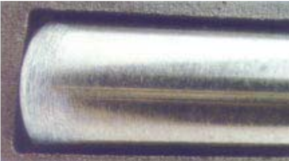
Figure 4 L'effritement à l'extrémité du diamètre majeur du rouleau conique indique que l'ajustement de ce roulement est trop serré
