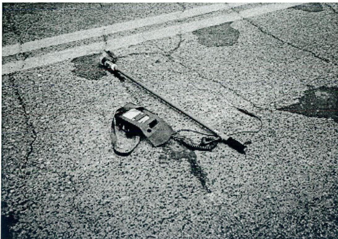
La mesure du potentiel de corrosion est subdivisée en 4 niveaux auxquels sont associés un degré d'importance de l'activité de corrosion :
