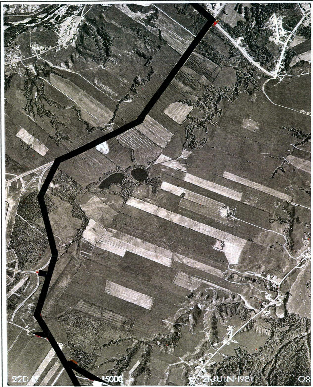
Figure 6 Localisation sur photo aérienne du projet 3671-9607, route 381, phase II, correction de tracé – nouvelle route, La Baie (2/3)
