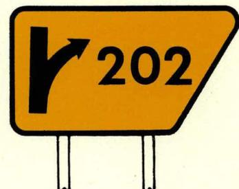
A.5.28a — Panneau de confirmation de sortie installé dans le musoir
